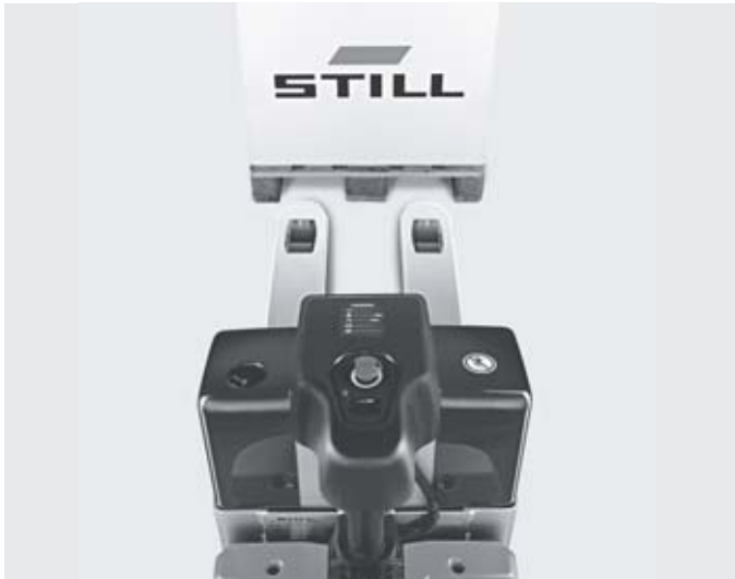
Превосходная производительность и обзор кончиков вилок за счет низкого корпуса
