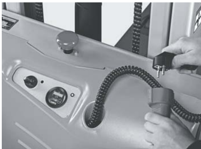
Încărcătorul încorporat garantează o disponibilitate maximă și permite o încărcare descentralizată
