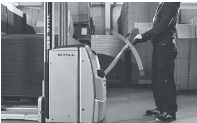
Siguranță în producție: în funcție de unghiul manetei de operare, viteza este adaptată automat la distanța dintre operator și stivuitor
