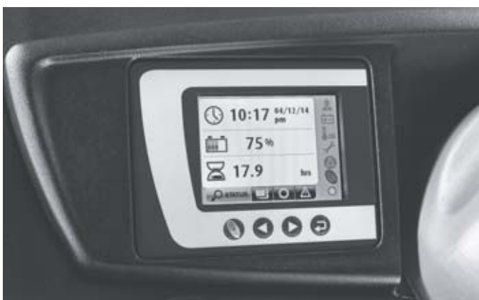
Vizibilitate completă în permanență: ecranul color cu o serie de simboluri independente de limbă afișează toate funcțiile importante dintr-o privire
