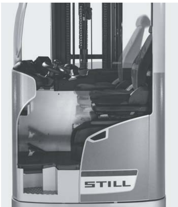
Poziție optimă din punct de vedere ergonomic, datorită scaunului ajustabil în funcție de greutatea operatorului și posibilității de reglare a platformei pentru picioare
