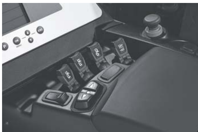
Toate funcțiile sunt ușor de operat, fără a fi necesară prinderea elementelor de comandă, datorită posibilității de operare cu vârful degetului
