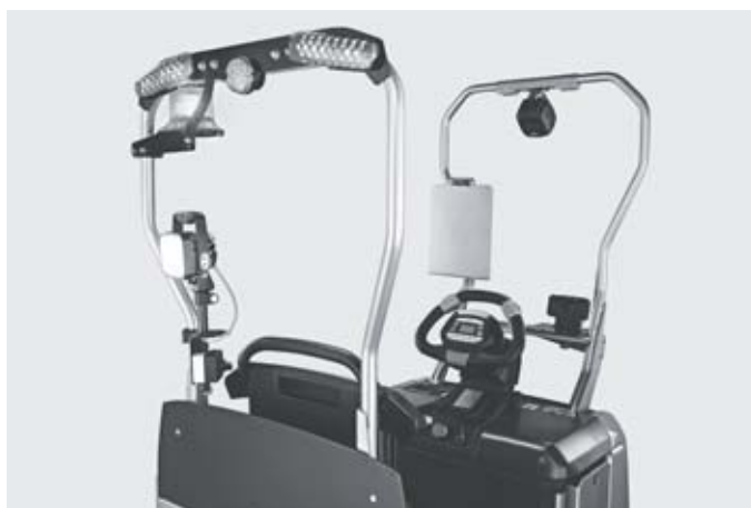
Cuier accesorii opțional pentru multiple utilizări și variante de dotare cu reflector și faruri de lucru
