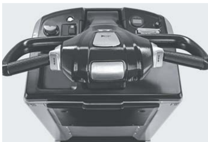
Post de lucru al operatorului cu elemente de operare intuitive
