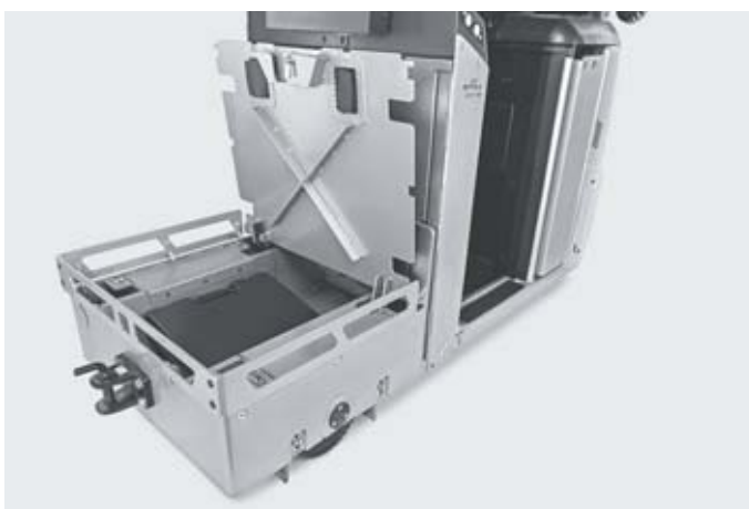
Compartimentul de depozitare situat pe platforma de transport
