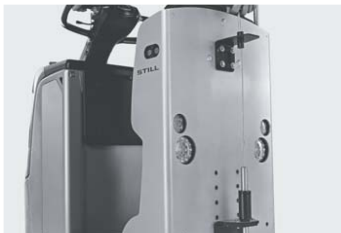
Deblocarea rapidă a cuplajului de pe scaunul operatorului
