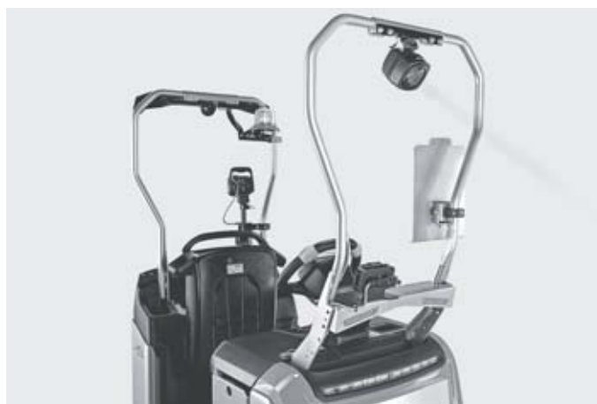
Vizibilitate optimă a autovehiculului grație sistemului opțional Safety Light și a sistemului Safety Light 4Plus pentru siguranța maximă în operare
