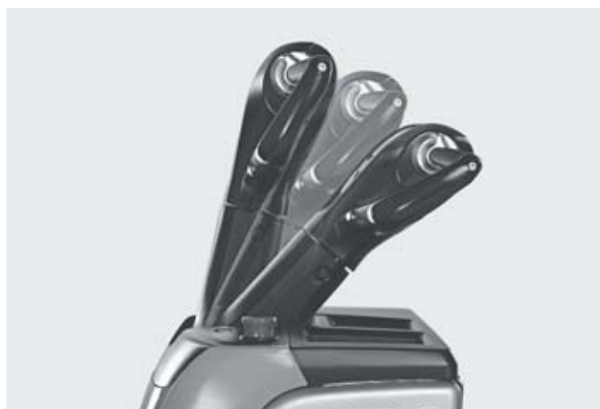
Volan reglabil pe înălțime, în funcție de operator
