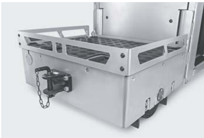
Utilizare flexibilă: vehicul de transport cu cuplaj pentru remorcă
