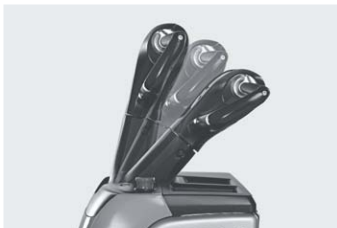
Регулируемое по высоте рулевое управление для операторов разного роста
