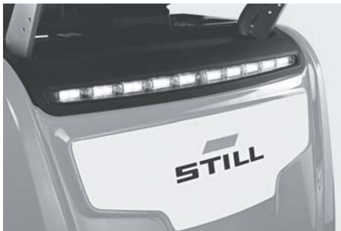
Светодиодные фары дневного света для повышения видимости машины и безопасности труда (опция)
