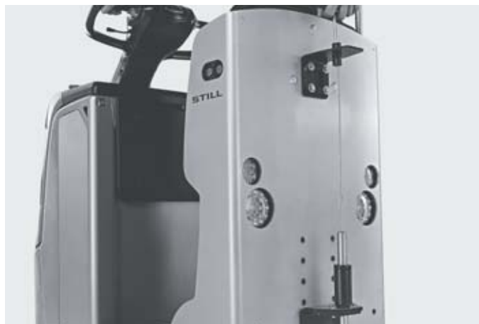
Быстрая разблокировка сцепного устройства с водительского места
