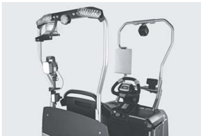
Вспомогательный кронштейн для различных возможностей использования и варианты комплектации с проблесковым маячком и фарами рабочего освещения (опция)
