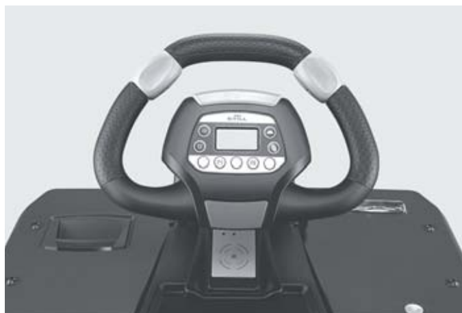
Уникальное рулевое колесо STILL Easy Drive для улучшения навыков управления движением и управления всеми функциями без необходимости перехватов
