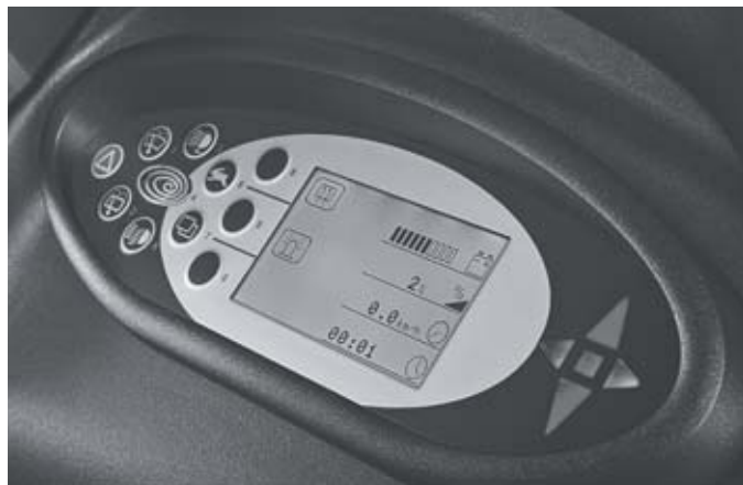
Индикатор крутизны преодолеваемого уклона при движении на спуске и подъеме
