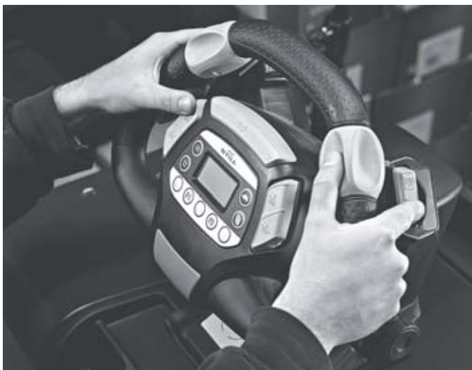
Уникальное рулевое колесо STILL Easy Drive для улучшения навыков управления движением и управления всеми функциями без необходимости перехватов
