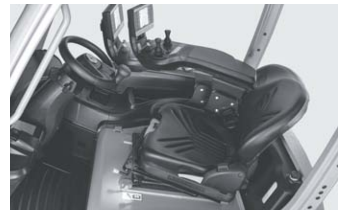
Scaun pivotabil pentru facilitarea deplasării în marșarier
