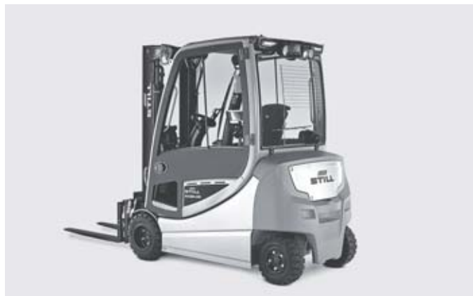
Versiune cu patru roți și cabină completă pentru utilizare în exterior
