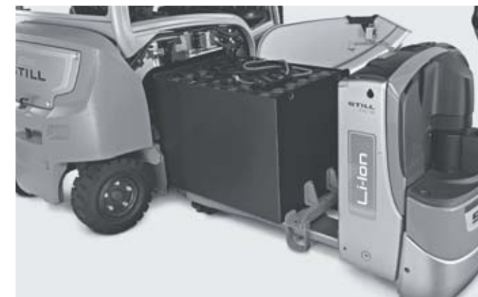
Înlocuirea bateriei pentru stivuitoorul electric de paleți
