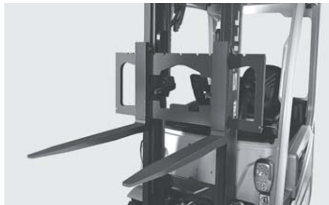
Vedere optimă a vârfului furcii când se încarcă sarcini grele
