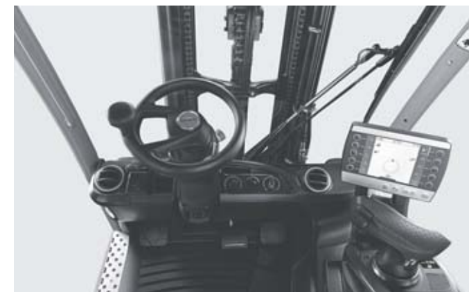
Post de lucru cu afișaj și comenzii, Joystick 4Plus și încălzire
