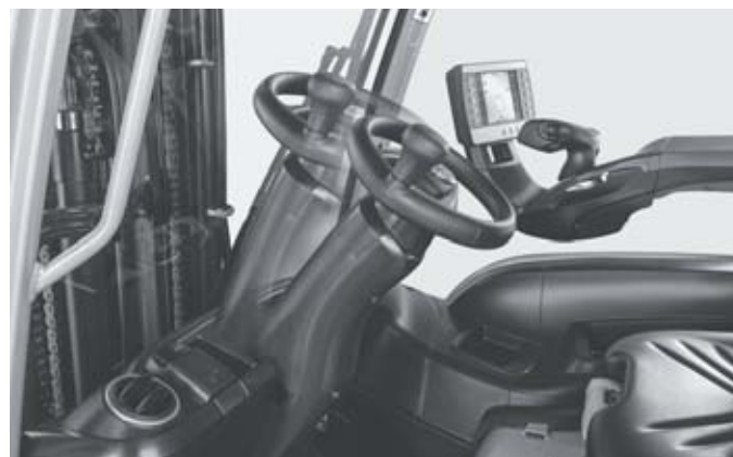
Reglare sus/jos din scaunul operatorului
