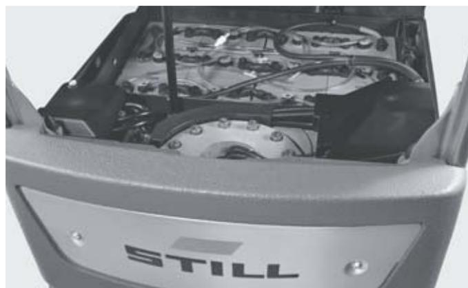
Прямой доступ к АКБ благодаря широко открывающейся крышке отсека
