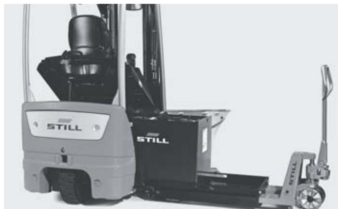
Простая замена АКБ сбоку при помощи стандартных ручных тележек и стэнда для замены АКБ
