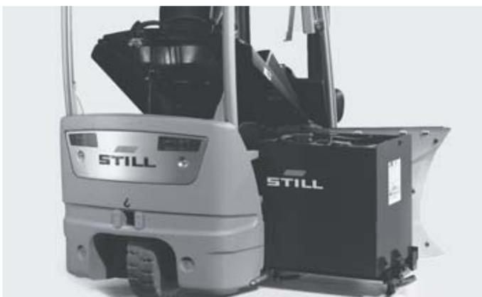
Секция АКБ для боковой замены аккумулятора при помощи крана
