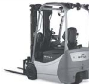
RX 50 является самым компактным электрическим 3-х опорным погрузчиком с противовесом в своем классе. Он отлично дополняет модельный ряд электрических погрузчиков STILL: благодаря многочисленным обновлениям он устанавливает новые стандарты обработки грузов массой от 1 до 1,6 тонн.
