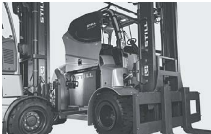
Высокая эксплуатационная готовность благодаря быстрой замене аккумуляторной батареи
