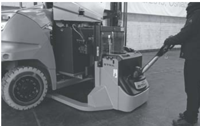
Быстрая замена АКБ при помощи электрической тележки ECU 30
