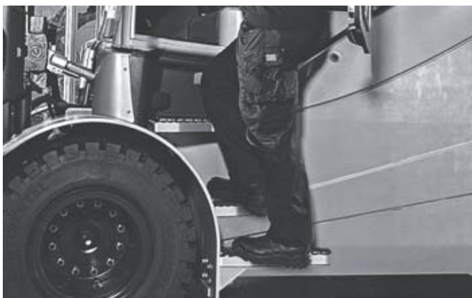
Безопасный вход/выход благодаря хорошо обозримым сверху ступеням с противоскользящим покрытием
