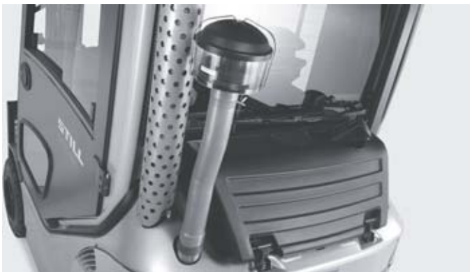
Циклонный воздушный фильтр для чистого забора воздуха двигателем
