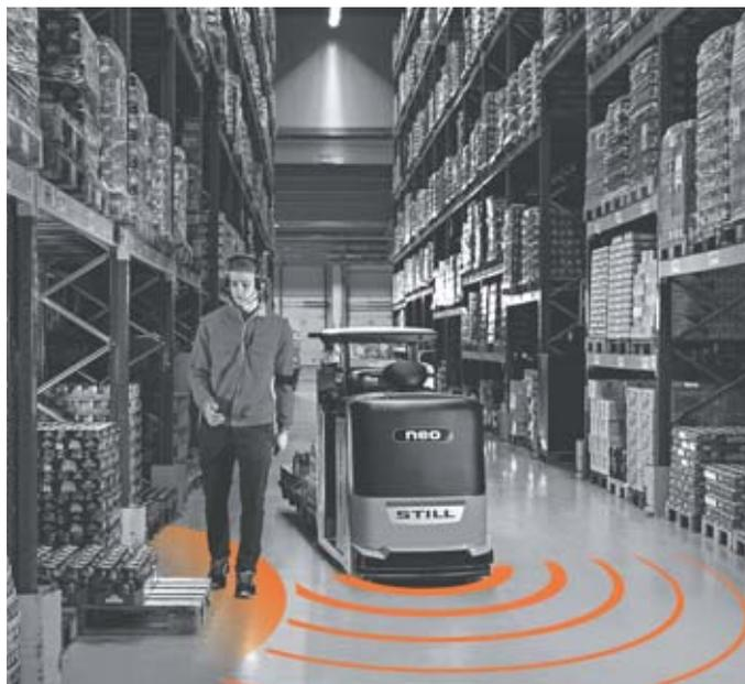
Точность при огибании препятствий: iGo neo CX 20 самостоятельно объезжает препятствия и действует по ситуации. Машина либо огибает препятствия, объезжает их при движении в колонне, либо останавливается, если они полностью блокируют путь.
