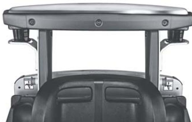
Светодиодный сигнал показывает, работает ли комплектовщик в автономном или ручном режиме.
