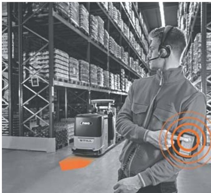
Безопасность процесса даже при пустых стеллажах или на пересечениях проходов: iGo neo CX 20 распознает пустые стеллажи и минует их. Машина также заранее фиксирует поперечные проходы и только с разрешения оператора, если путь свободен, самостоятельно их пересекает.
