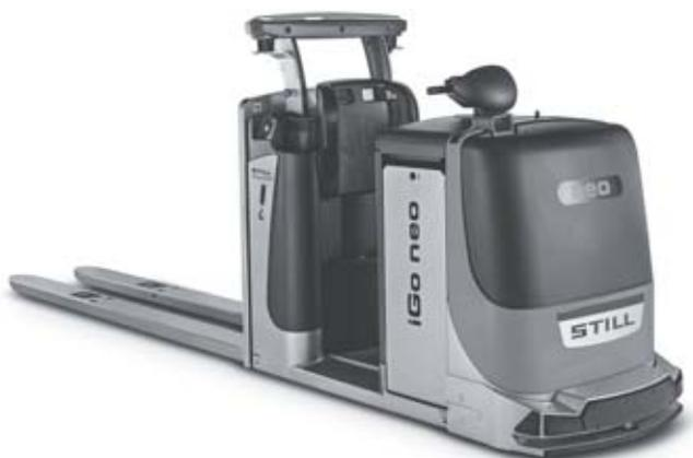
Превосходное сочетание интеллектуального решения и надежной конструкции: вся робототехническая система заключена в контур комплектовщика. Оптимальная защита компонентов предотвращает появление повреждений в узких проходах.
