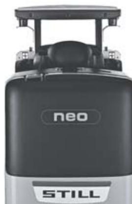
Высочайшая степень безопасности благодаря датчикам отслеживания движения: автономный комплектовщик способен распознавать оператора, прочих лиц и препятствия.
