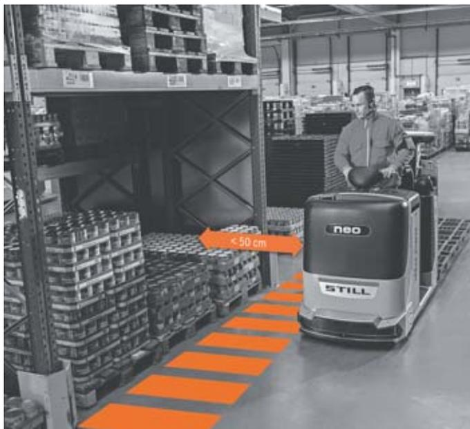
Соблюдение индивидуальных предпочтений в отношении комплектации заказов: iGo neo CX 20 просто остановить у желаемого места. Машина самостоятельно выдерживает точную дистанцию до стеллажа, заданную оператором. Если безопасное расстояние в 500 мм не соблюдается, машина скорректирует удаление от стеллажа, заново к нему подъехав. Местонахождение комплектовщика по отношению к оператору и расположению стеллажа можно скорректировать дистанционно. Это, в свою очередь, сокращает траекторию движения.
